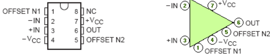
Şekil 14. UA741CN ve \mu A741C Op-Amp entegrelerinin bacak bağlantıları
