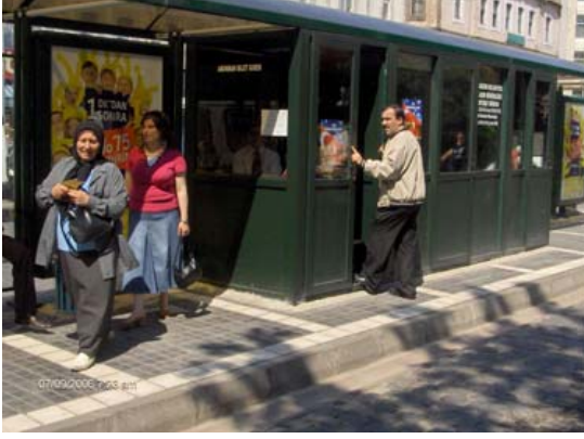
Şekil 158. Tekerlekli sandalye kullanan engelliye uygun olmayan bilet gişesi
