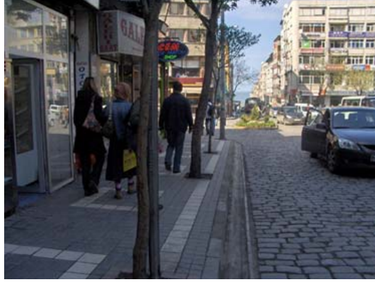
Şekil 167. Kaldırım üzerinde yer alan ağaçlardan kaynaklanan yetersiz geçiş alanı
