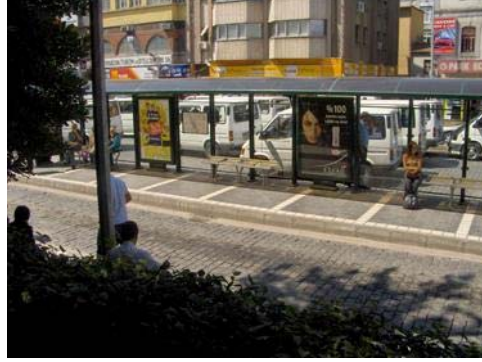
Şekil 157. Tekerlekli sandalye kullanan bedensel engellilerin rahat binişlerini sağlamak için yükseltme platformu yapılmamış otobüs durakları
